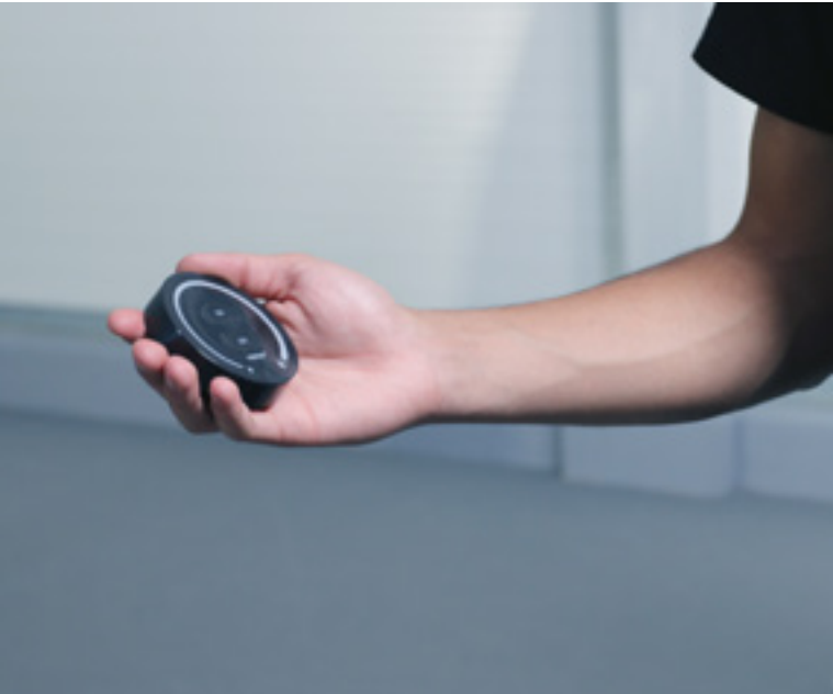
Fernbedienung für die Beleuchtung (Ein-/Ausschalten und Dimmfunktionen)
